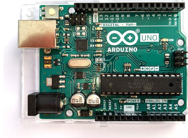
**Abbildung 1** Arduino UNO R3
